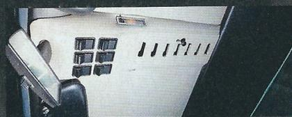
◀ Veilleuse, antibrouillards et chauffage se commandent au plafond, comme la grille de ventilation de l'habitacle.
