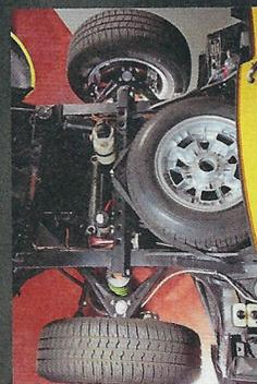
▲ Sous le grand capot avant, il n'y a presque rien : la crémaillère de direction, le radiateur et la roue de secours.
