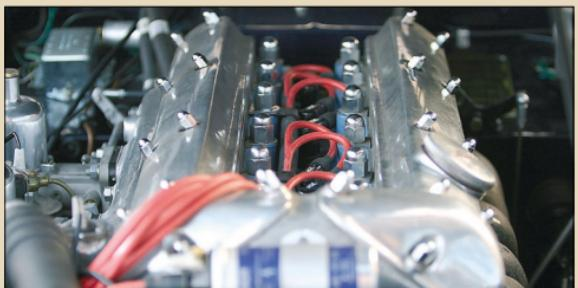
Le moteur 6 cylindres XK (ici en version standard de 190 ch) a nécessité l'emploi d'un nouveau radiateur incliné à 60°.
