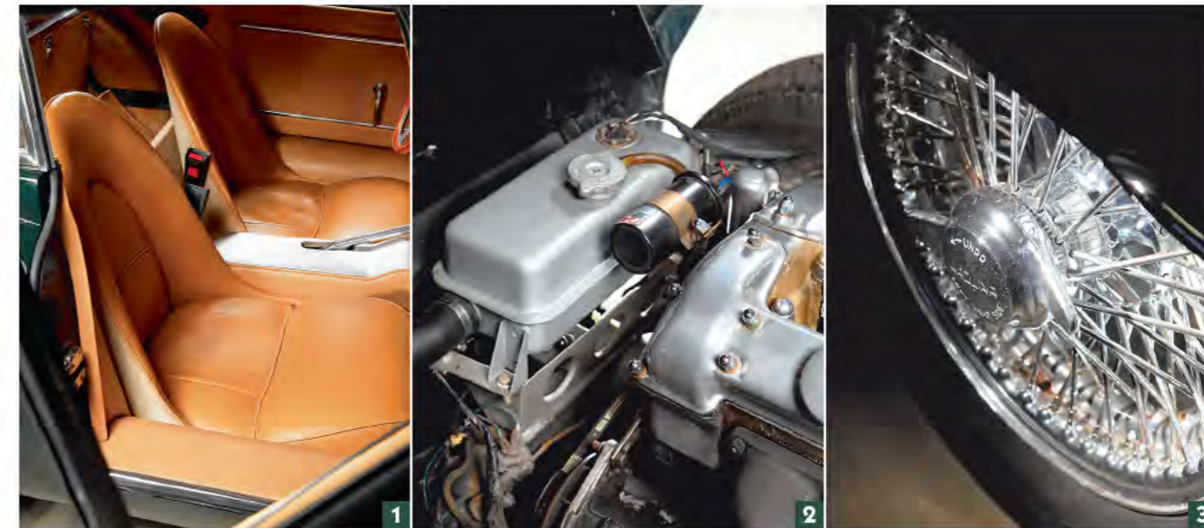
1. Un habitacle rénové dans les règles de l'art. 2. Le refroidissement est l'un des talons d'Achille du modèle. Il ne doit souffrir d'aucune négligence. 3. Les roues fil doivent être en parfait état. Sécurité et précision de conduite en dépendent.
