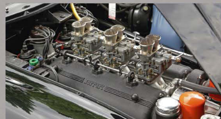
Le bloc "Colombo" se contente ici de trois carburateurs Weber. Mais l'usine en proposait six en option, au besoin...
