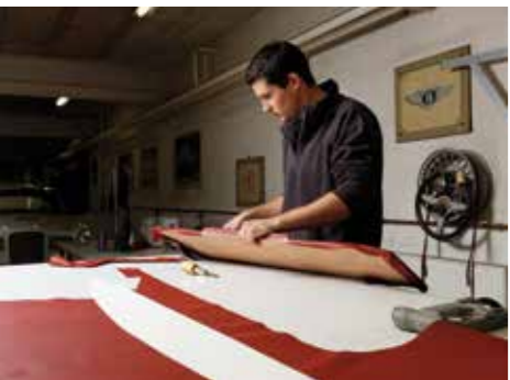
Yvan, en pleine réfection d'un panneau de porte de Facel Vega HK 500.
