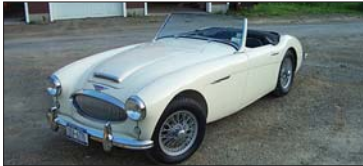
Austin-Healey 3000 Mark II, types BN7 et BT7 – Calandre à lames verticales, 3 carburateurs SU, 132 ch.
