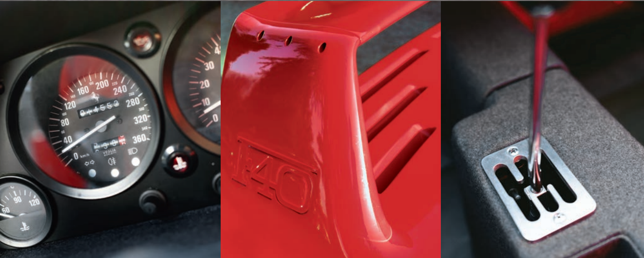
Un compteur qui affiche 360 km/h et fait fantasmer, un aileron arrière intégré au volumineux capot moteur qui nécessite trois jours de fabrication et enfin le levier de vitesse planté dans sa grille reconnaissable avec ses cinq rapports.
