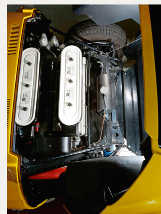
Avec sa boîte en dessous, et sa position transversale, le gros V12 de presque 4 litres paraît plutôt compact.
