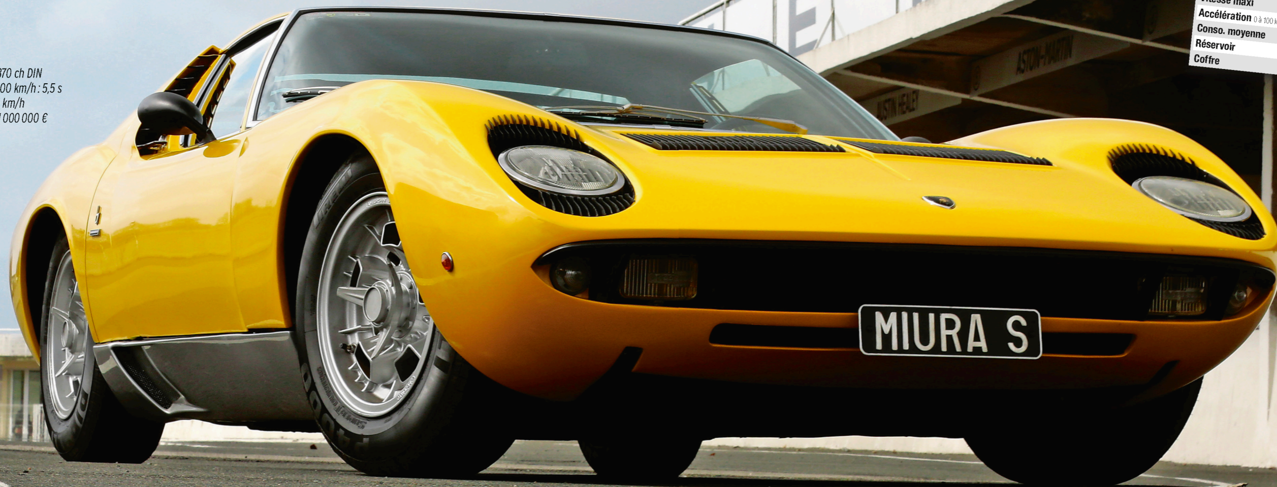
Son avant en pointe et son soubassement caréné ont la fâcheuse tendance à la faire décoller à très haute vitesse.
