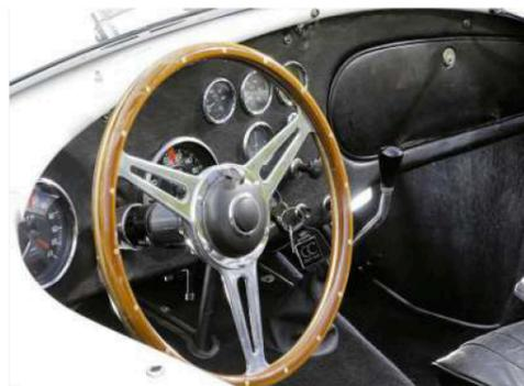
▲ Seule folie dans cet habitacle où la fonctionnalité l'emporte, l'actionneur des clignotants placé sur le moyeu du volant.
