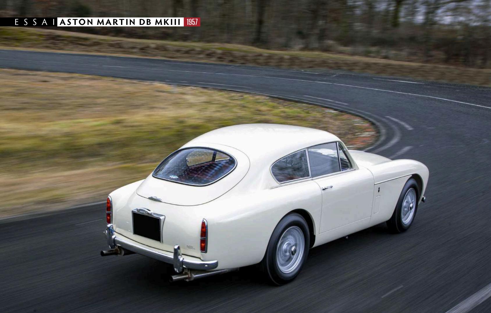
LA DB MKIII DISTILLE DES SENSATIONS DE CONDUITE PLUTÔT RUSTIQUES, AVEC SON PONT ARRIÈRE RIGIDE GUIDÉ PAR DES BARRES PANHARD.
