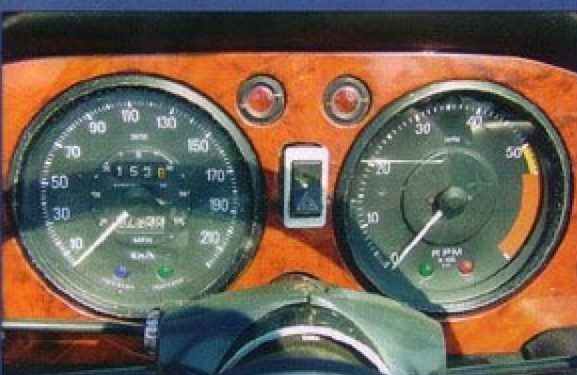
Le compteur est gradué en km/h et le compte tours affiche une zone rouge à 5000 tours/min. Pas besoin de recourir aux derniers tours moteur pour que celui-ci distille toute sa puissance !
