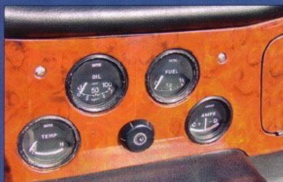
Les manomètres renseignent le conducteur de tout ! Le niveau d'essence, la pression d'huile, la température moteur ainsi que la charge batterie sont indiqués. Notez la présence d'une micolette de rhéostat de luminosité des compteurs.
