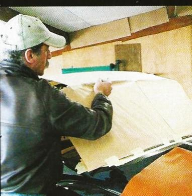
Le sellier passe souvent beaucoup de temps à refaire ce qui ne se voit pas : l'armature, les ressorts, le rembourrage, les fixations, etc. Autre aspect du métier : la réfection des capotes. Là encore, souplesse et tension doivent être judicieusement conjuguées.
