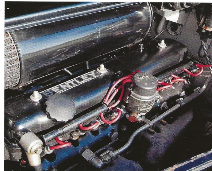
La Mk VI hérite du 6 cylindres 4,250 l qui a largement fait ses preuves depuis 1936. Très coupleux et raisonnablement puissant, il constitue l'un des points forts de la voiture. Sur la route, sa vivacité contribue pleinement au plaisir de conduire.
